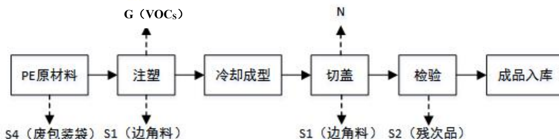
图 3.2-2 项目瓶盖生产工艺及 VOCs 产污节点图
